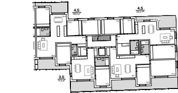
Über der Kita in 2. und 3. Obergeschoss befinden sich eine 3.5- und eine 4.5-Zimmer-Wohnung mit grosszügiger Überdachung.
