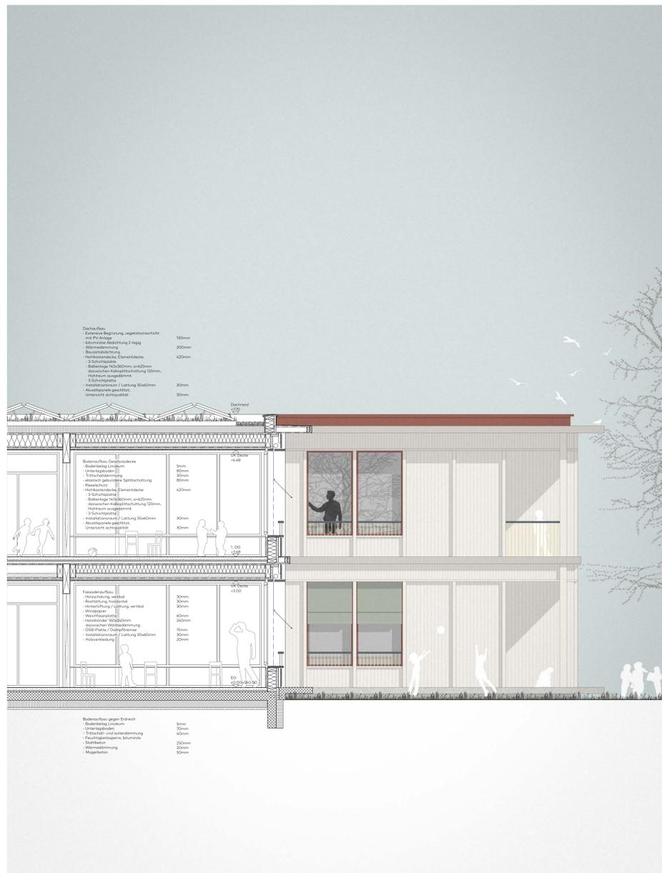
Fassadenschnitt Neubau Basisstufe 1:50
