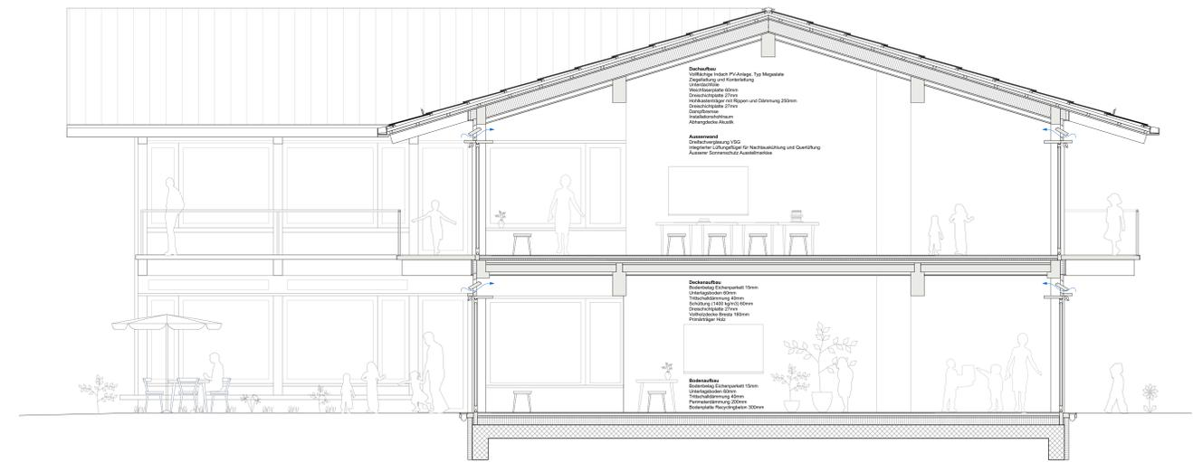
Konstruktionsschnitt Basisstufe mit Ansicht 1:50
