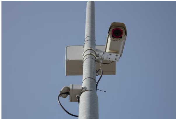
Abbildung 8: Montage Infrarotkamera mit Mess-PC und beispielhafte Infrarotbild-Aufnahme einer TIM 40 Kamera vom 21.08.2022 um 15 Uhr. (Die angegebenen Durchschnittstemperaturen entsprechen dem jeweiligen Mittelwert der gewählten Belagspixel zum genannten Zeitpunkt.)
