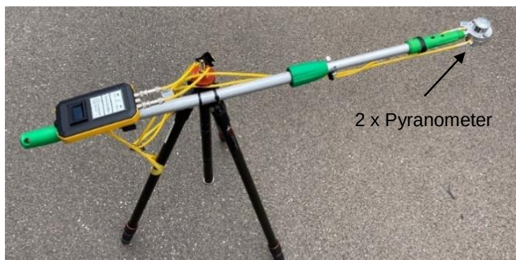
Abbildung 10: Albedometer zur Bestimmung der Belagsalbedo.
