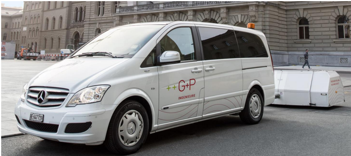
Abbildung 11: CPX Messfahrzeug mit Anhänger zur direkten Messung der Reifen-Fahrbahngeräusche
