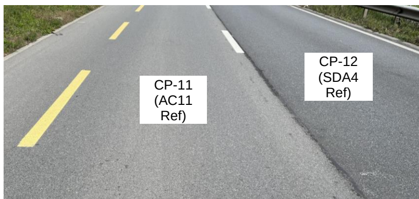
Abbildung 14: Vergleich der zwei Standardbeläge dichter und semidichter Bauweise im September 2022. Der AC 11 Belag ist deutlich heller als der SDA 4 Belag.
