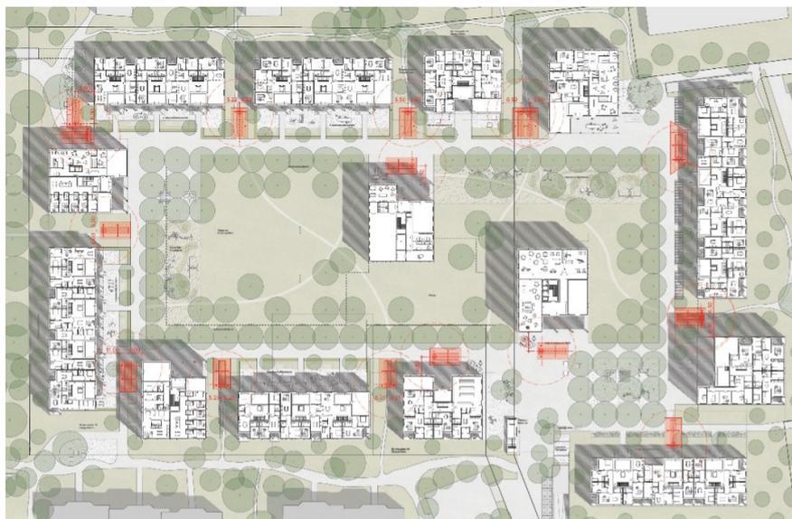
Abb. 13 Situationsplan Notfallfahrzeuge aus dem Richtprojekt mit Standplätzen für Notfallfahrzeuge in rot markiert.
