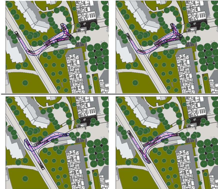
Abb. 14 Untersuchung der Wendemöglichkeiten mit unterschiedlichen Lastwagentypen und Wendevorgängen (Untersuchung der Kontextplan AG): Oben links VSS Lastwagen Typ B (Wendevorgang 1), oben rechts MAN Hakenfahrzeug (Wendevorgang 1), unten links VSS Lastwagen Typ 1 (Wendevorgang 2), unten rechts MAN Hakenfahrzeug (Wendevorgang 2).
